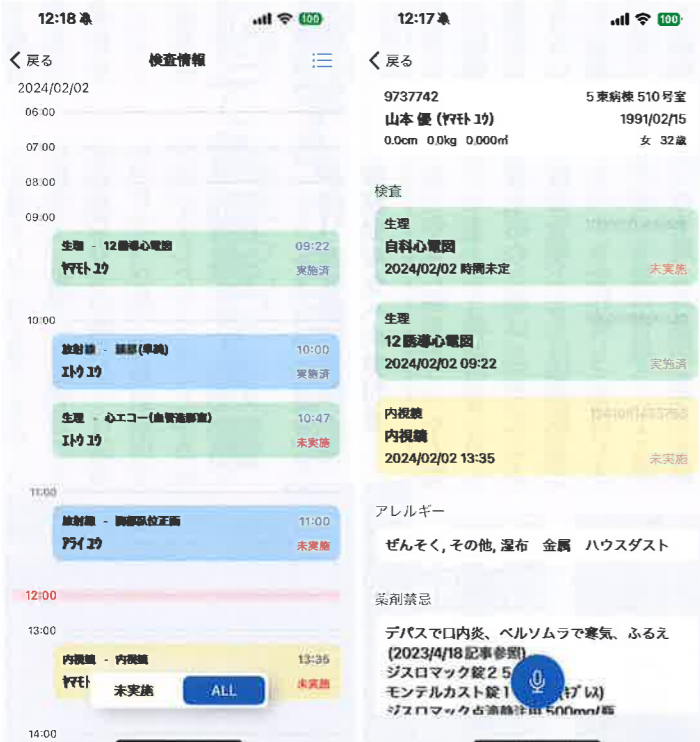
開発中の看護師アシストシステムの画面。検査情報の画面（左）では検査の実施が決まると即座に情報が更新される。患者の個別情報の画面（右）では検査の予定やアレルギー、薬剤禁忌が表示される
